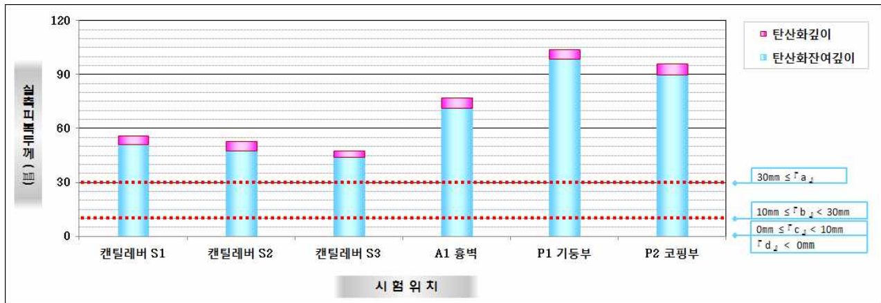
【그림 3.4.17】 탄산화 깊이 측정결과(부산)
