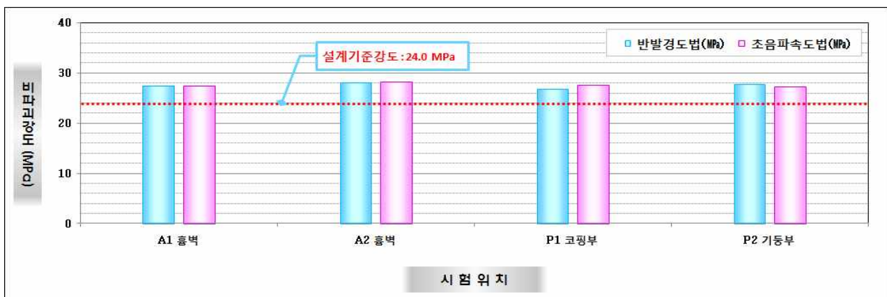
【그림 3.4.12】 하부구조(교대, 교각) 평균압축강도 추정결과(대구)
