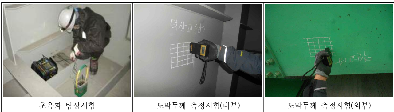
【사진 3.5.1】 강재 비파괴시험 전경
