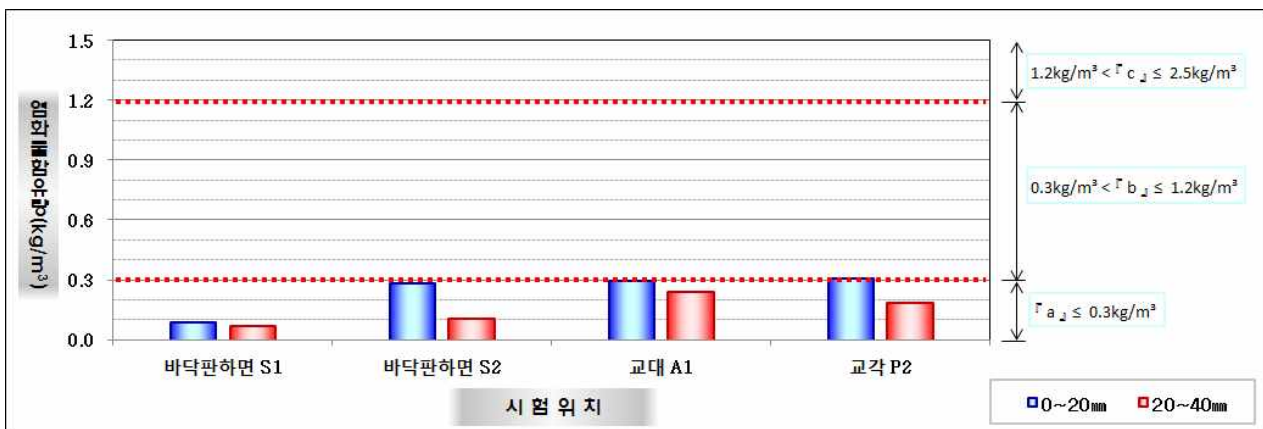
【그림 3.4.14】 염화물시험 측정결과(대구)
