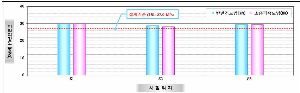
【그림 3.4.15】 상부구조(바닥판하면) 평균압축강도 추정결과(부산)
