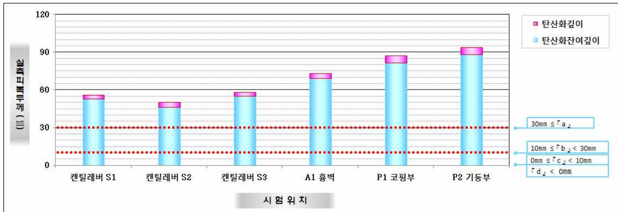
【그림 3.4.13】 탄산화 깊이 측정결과(대구)
