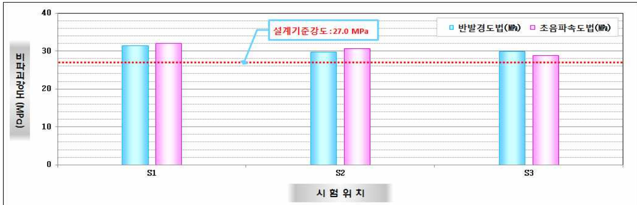
【그림 3.4.11】 상부구조(바닥판하면) 평균압축강도 추정결과(대구)
